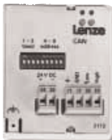
EMF2172IB: Im Gegensatz zur Baugruppe EMF2171IB verfügt die Baugruppe EMF2172IB über DIP-Schalter zur Vorgabe der Knotenadresse und der Baudrate.
